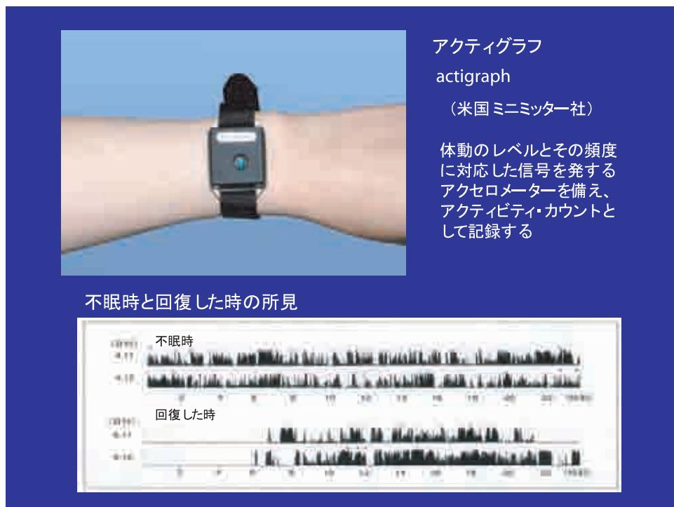
図3 アクティグラフ（上図）とこれを不眠患者に用いた際のデータ（下図）
